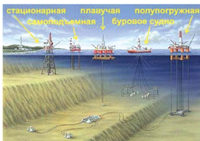
Рис. 1. Основные типы платформ для обеспечения нефтегазодобычи на морских месторождениях [1]
